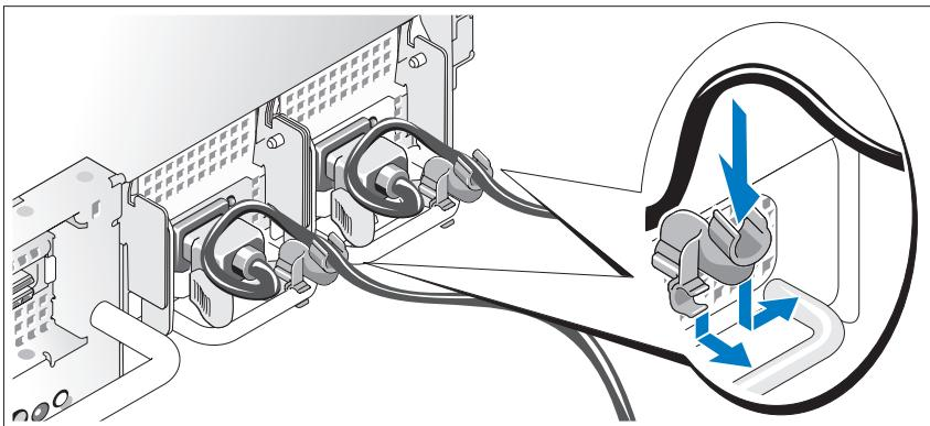
חבר את כנ הקיבוע של כבל החשמל לצד הימני של ידית ספק הזרם. צור לולאה בכבל החשמל של המערכת, כמו צג באירור, ו לחבר את הכבול לתפס שעל הכנ. חבר את הקצה השני של כבל החשמל לשקע חשמלי מוארך או למקור חשמל נפרד, כגון אל-פסק (UPS) או ליחידת חלוקת חשמל (PDU).
