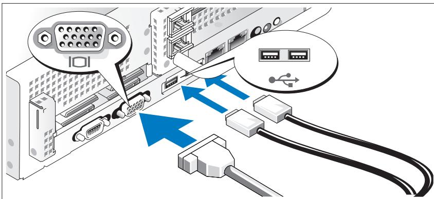
Подключите клавиатуру, мышь и монитор (дополнительно).
