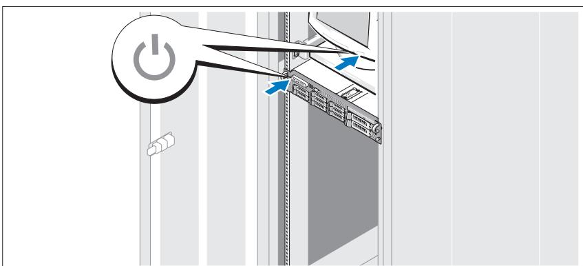
Presione el botón de encendido del sistema y del monitor. Los indicadores luminosos de alimentación deberían encenderse.
