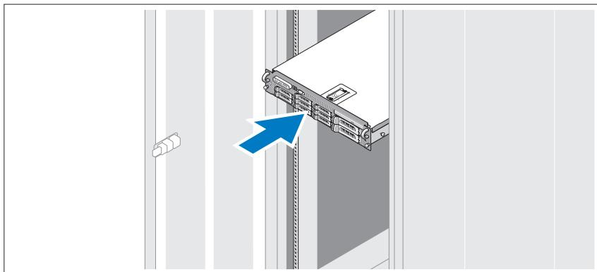
Смонтируйте направляющие кронштейны и установите системы в стойку согласно инструкциям по технике безопасности и инструкциям по монтажу в стойку. Эти инструкции прилагаются к вашей системе.
