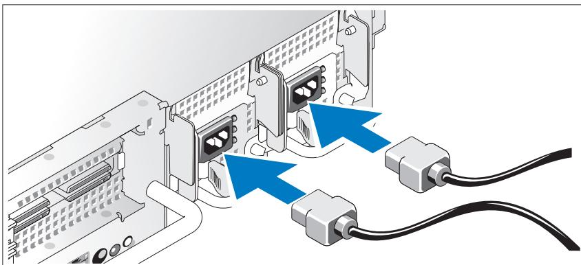
Подключите силовой кабель к системе. Если используется монитор, то подключите и к монитору его силовой кабель.
