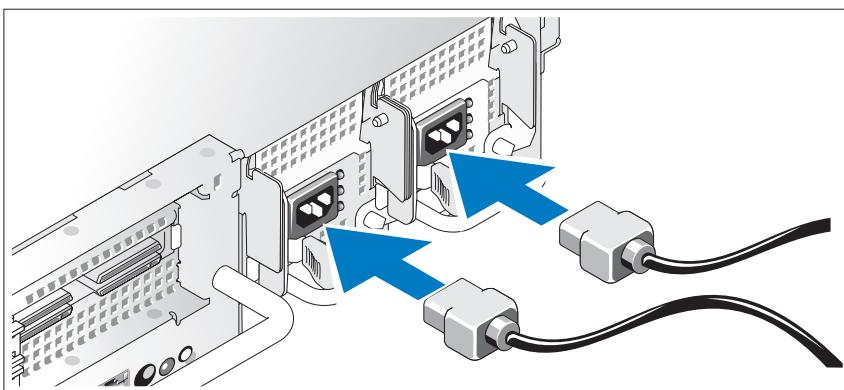
Podłącz kabel (kable zasilania) do komputera, w przypadku korzystania z monitora podłącz do niego jego kabel zasilania.
