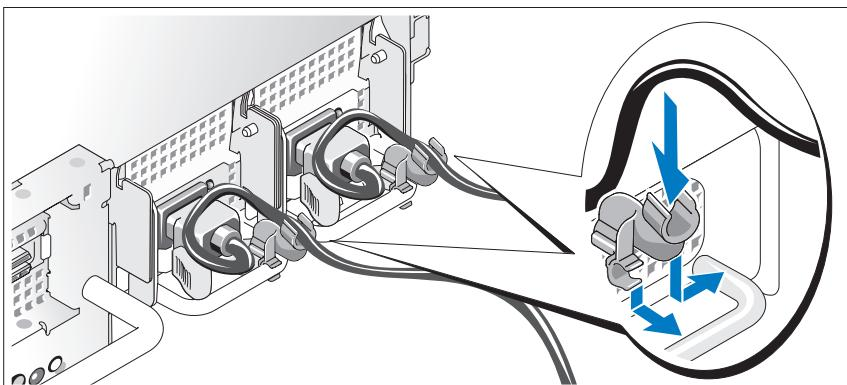
Fije el soporte de retención del cable de alimentación en el codo derecho del asa de la fuente de alimentación. Doble el cable de alimentación del sistema en forma de bucle, tal como se muestra en la ilustración, y fíjelo a la abrazadera correspondiente del soporte.
