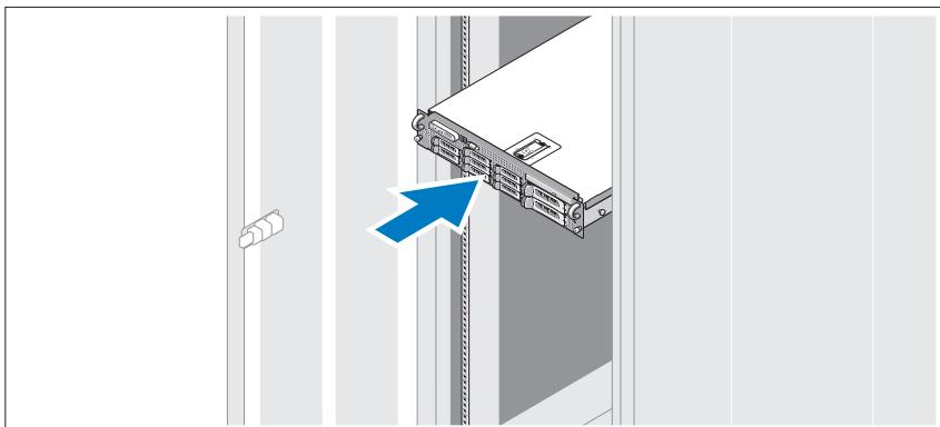
Sestavte vodicí lišty a nainstalujte systém do stojanu podle bezpečnostních pokynů a pokynů pro instalaci stojanu, dodaných se systémem.
