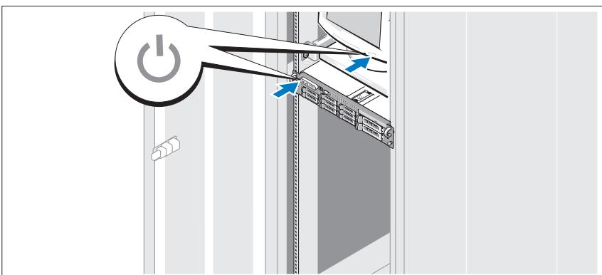
Stiskněte vypínač na systému a na monitoru. Kontrolky napájení by se měly rozsvítit.
