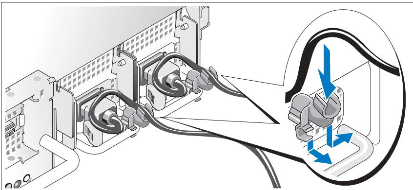
Bringen Sie die Halteklemme für das Netzkabel am rechten Bogen des Netzteilgriffs an. Biegen Sie das Netzkabel wie abgebildet zu einer Schlaufe, und befestigen Sie es an der Kabelklemme der Halteklemme.
