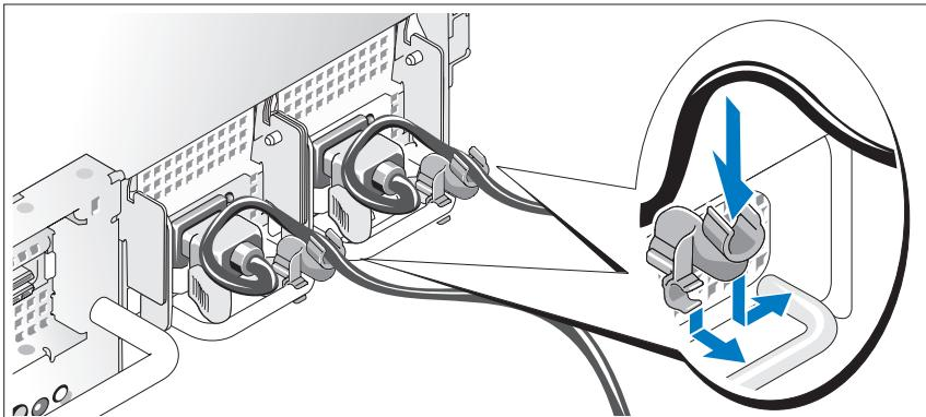
Συνδέστε το στήριγμα συγκράτησης του καλωδίου τροφοδοσίας στο δεξί σύνδεσμο της λαβής της παροχής τροφοδοσίας. Κάμψτε το καλώδιο τροφοδοσίας του συστήματος σε μορφή βρόχου όπως φαίνεται στο σχήμα και συνδέστε το στην αγκράφα του καλωδίου του στηρίγματος.
