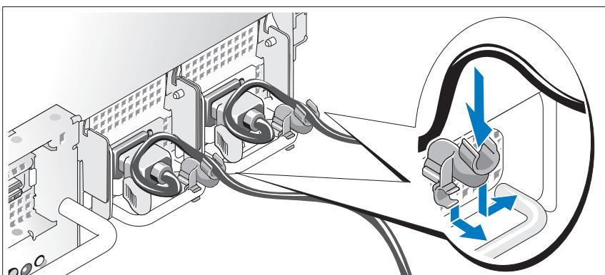
Podłącz wspornik podtrzymujący kabel zasilania do prawego węzła na uchwycie zasilacza. Zegnij kabel zasilacza, tworząc pętlę, w sposób przedstawiony na rysunku i przymocuj do zacisku kabla na wsporniku.
