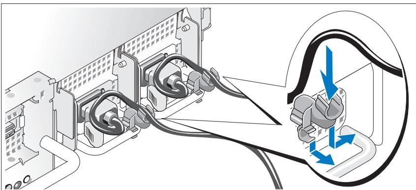
Připevněte držák napájecího kabelu do pravého ohybu rukojeti napájecího zdroje. Udělejte na napájecím kabelu smyčku, jak je znázorněno na obrázku, a připevněte ho do příslušného úchytu.
