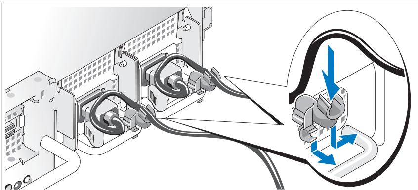
Прикрепите кронштейн фиксации на правом изгибе рукоятки разъема шнура питания. Согните системный шнур питания в петлю (см. рисунок) и прикрепите его к кабельному зажиму кронштейна.
